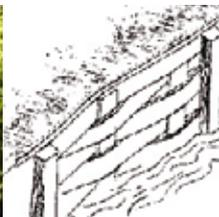
**Le tunage (clayonnage)** : les clayons sont des lamelles de bois tressés ou petites planches retenues par des piquets pour soutenir des terres et les empêcher de s'ébouler.
