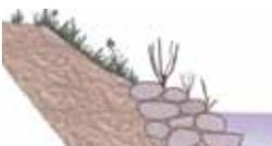
**L'enrochement** est un ouvrage de stabilisation de berges réalisé à l'aide de gros blocs de pierres (moellons bruts) à placer au pied ou en protection de berges.
